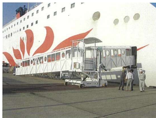
図-67 ボーディングブリッジの設置例 (志布志港)
